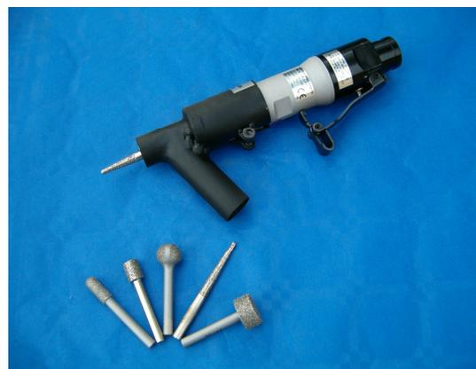
NAG pneumatisk ligesliber m. 6mm tang – en lille robust maskine - ø35mm i diameter og ca. 200mm lang) – kun 528 gr. komplet - 35.000 omdr./min.
